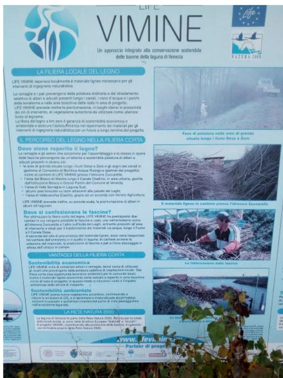
Il progetto Life Vimine, realizzato fra il 2013 ed il 2017 era finalizzato alla protezione delle barene dall'erosione con piccoli interventi di ingegneria naturalistica a basso impatto ambientale; niente barriere realizzate con reti di plastica o tessuto geotessile contenenti pietre e/o conglomerati cementizi ma semplici fascine, tenute ferme da una doppia fila di pali infissi nel fango che rendono tra l'altro l'intervento naturale e reversibile.
