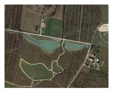
La realizzazione dei due specchi d'acqua non obbedisce all'esigenza di creare scorci suggestivi, ma a quella di sostituire la canaletta irrigua cementata larga 2,5 metri che correva lungo via Cosenz con uno specchio d'acqua che raggiunge i 90 metri di larghezza e le cui sponde sono sagomate con pendenze limitate in modo tale da favorire la colonizzazione di un alto numero di specie vegetali.
