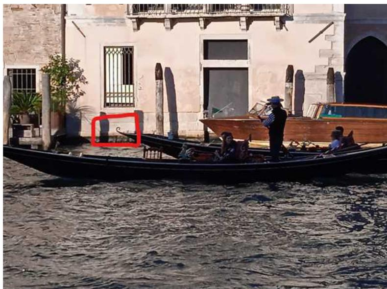
La differenza sostanziale della struttura dello scafo è che il sandolotto non è asimmetrico
