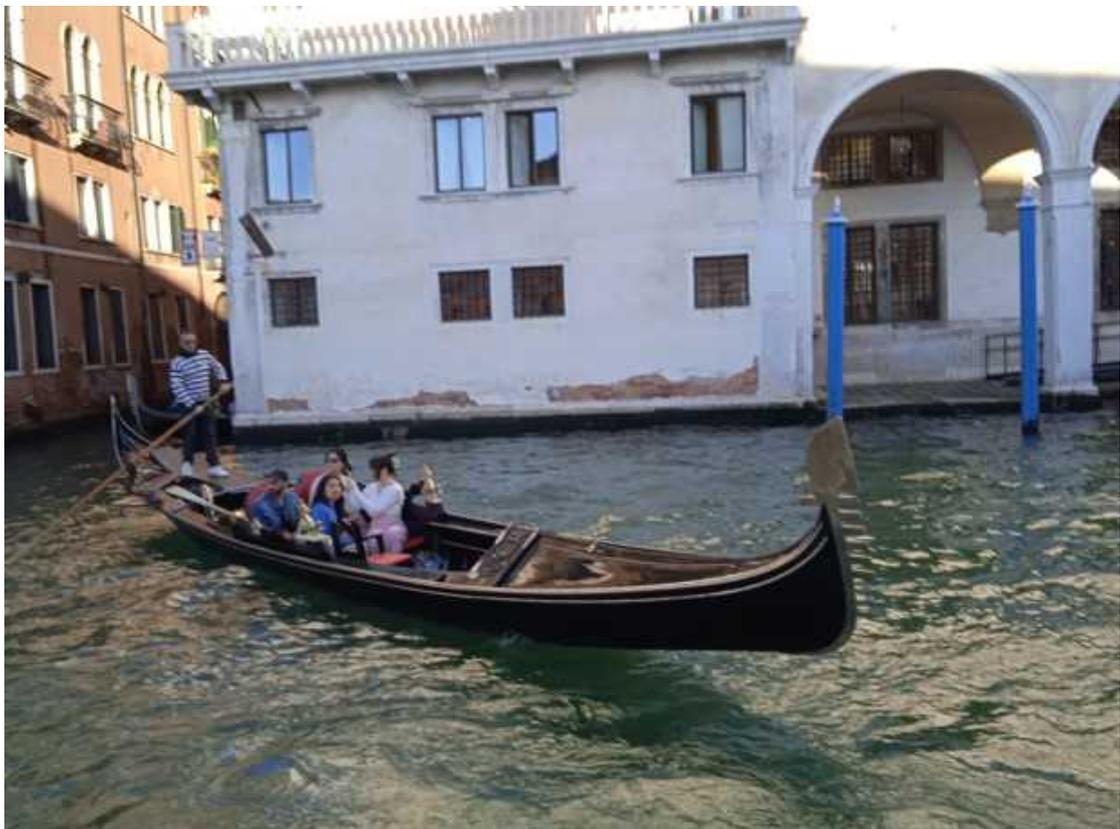
Proprio per la presenza del vogatore la asimmetria dello scafo non si nota se la gondola è in movimento; si nota benissimo, invece, che, mentre il vogatore della gondola si trova in piedi sopra la poppa della barca,
