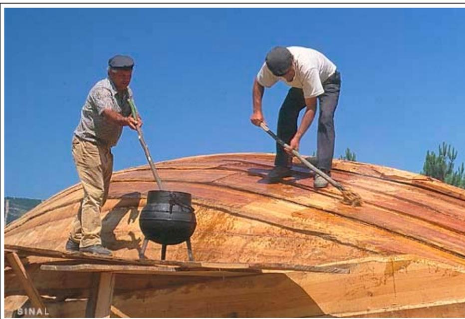
Depois de calafetado, o casco será embreado com pez louro, a que se adiciona um pouco de gordura de carneiro para correr melhor. Esta mistura é aquecida em panelas de ferro de três pés, e aplicada com escopeiros - uma espécie de pincéis feitos com pele de carneiro. Procede-se à embreagem pelo exterior e posteriormente por dentro do barco, o que vai exigir nova operação - o botar abaixo.
