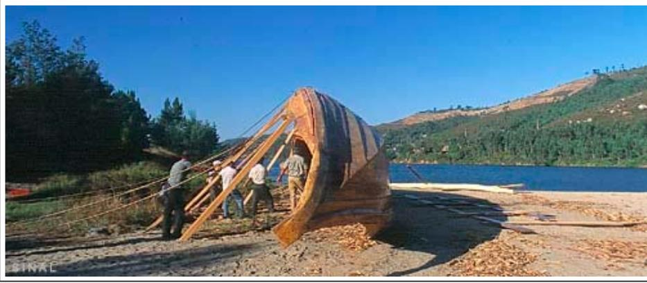
Nada de gado, unicamente gente a botar abaixo: os que pegam aos cabos das polés das jangadas para lascar o barco e os que, de lombos aos costados, amortecem o peso e o andamento da bisarma. Para botar abaixo usam uma escora que serve de alavanca, empurrando a parte média da borda livre do barco, conforme vai sendo accionada por um aparelho de força, que a desloca em direcção ao casco. Para muitos, o botar abaixo constitui espectáculo mais lindo do que o tombar.
